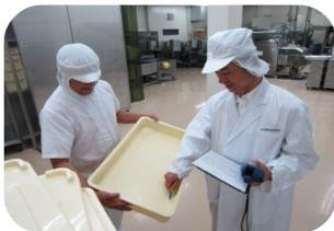
パン箱の洗浄が徹底されているか、ATP検査をしています。
