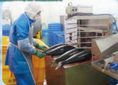
ブリの頭を機械で素早くカット！内臓も機械を使って除去します。
